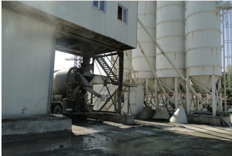
ბეტონის ნარევის ჩატვირთვა ავტობეტონშიდში
