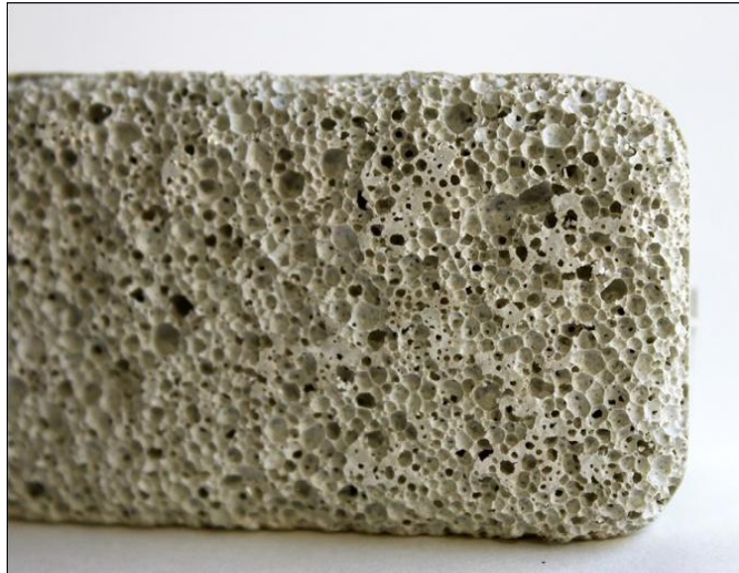
ზემსუბუქი ბეტონი (ქაფბეტონი)
