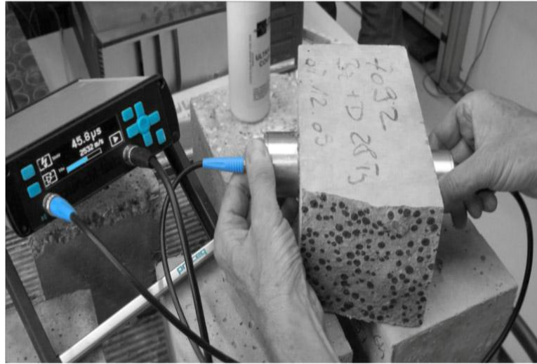
ულტრაბგერითი აპარატი ბეტონის სიმტკიცის განსაზღვრისთვის
