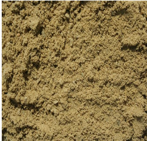
ბეტონის წვრილი ინერტული შემცვენი (ქვიშა)
