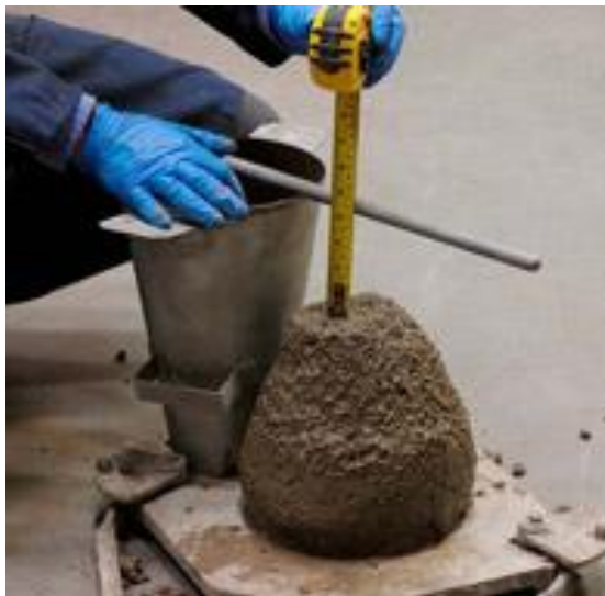
ბეტონის ჯდომის სიმაღლის განსაზღვრა
