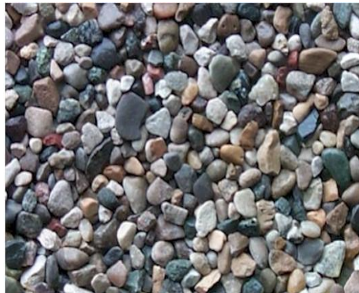
ბეტონის მსხვილი ინერტული შემცვენი (ხრეში)
