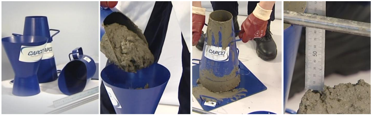
ბეტონის სიხისტის განმსაზღვრევი ხელსაწყო (ყალიბ კონუსი)
