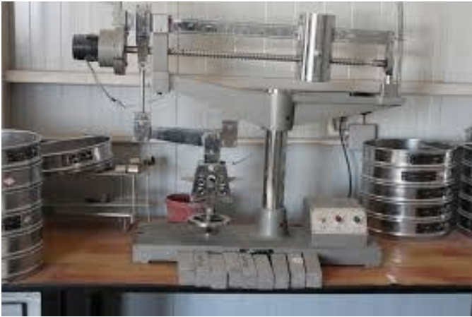
მოწყობილობა ცემენტის ძელის ღუნვაზე გამოსაცდელად
