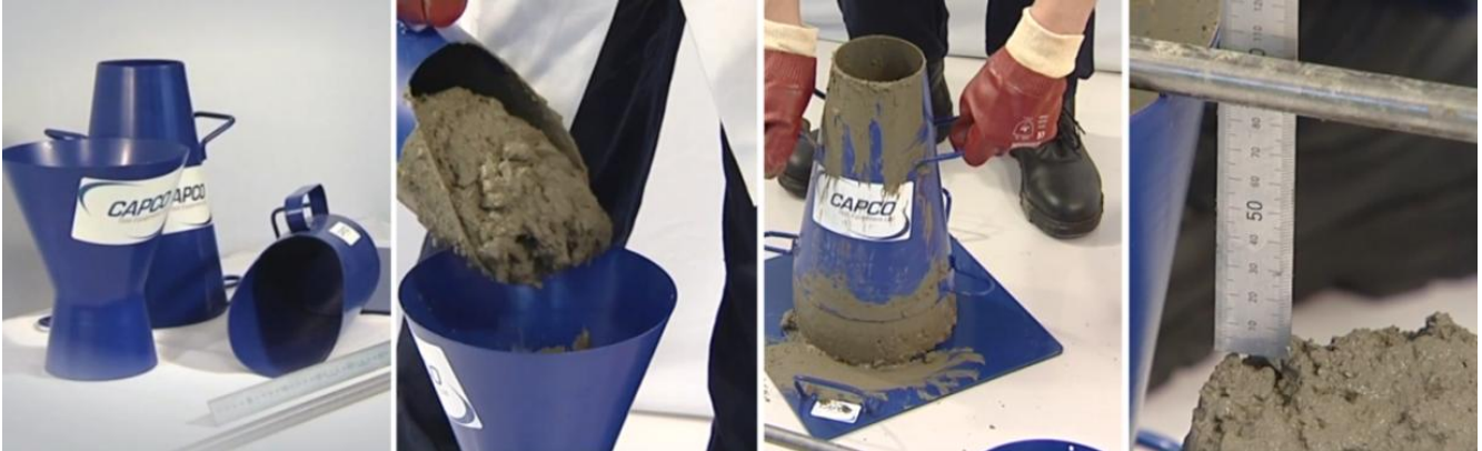
ბეტონის ნარევის სიხისტის განსაზღვრა
