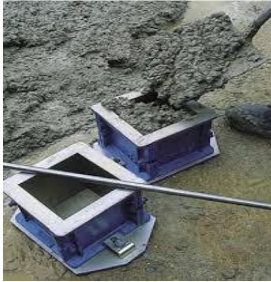
ბეტონის ნარევიდან საკონტროლო ნიმუშის აღება
