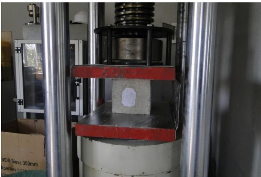
ჰიდრავლიკური წნეხი ბეტონის ნიმუშის სიმტკიცის განსაზღვრისათვის კუმშვაზე
