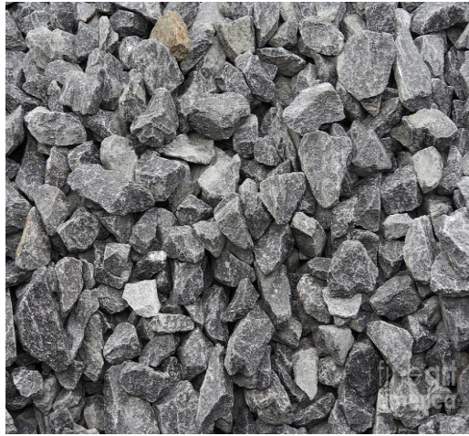
ბეტონის მსხვილი ინერტული შემცველები (ღორღი)
